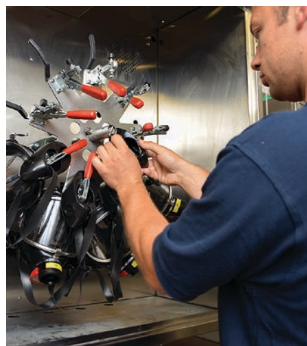
Trocknung – Atemschutzmasken in der Trocknungsanlage.
