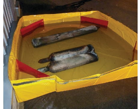
Aus dem Brandraum geborgene Gasflaschen mussten zur Sicherheit gekühlt werden.
