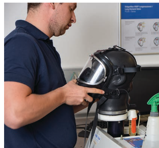
Prüfung – die Funktion der Atemschutzmasken wird auf sog. Prüfköpfen getestet.
